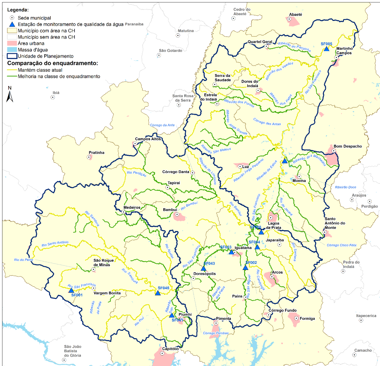
Figura 11.6 – Comparação do enquadramento proposto com a situação presente, na ocorrência da vazão de referência Q_{7,10} .
