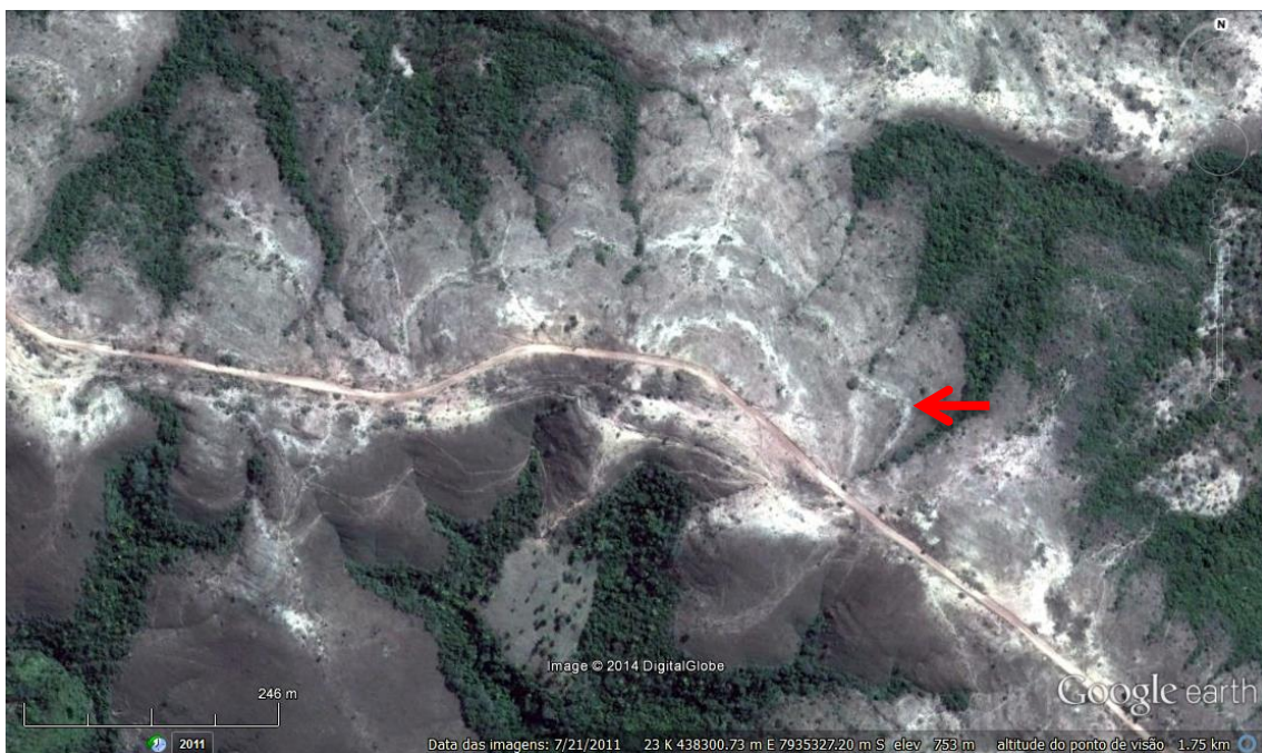
Figura 9.2 – Processos erosivos laminares no centro da UPRH SF4. A seta indica os caminhos preferencias de gado, resultando em áreas de solo exposto.
