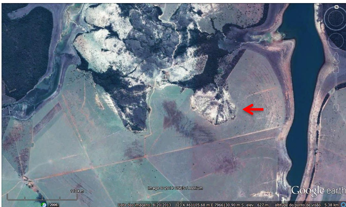
Figura 9.4 – Ocorrência de erosão laminar em uma área de borda de tabuleiro laterítico.
