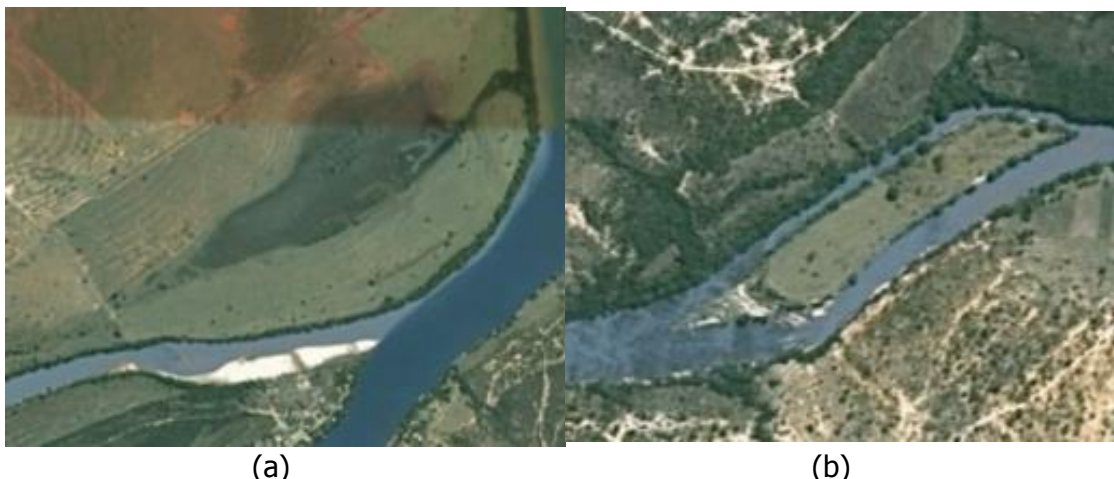
Figura 4.3 – (a) Depósito aluvionar na confluência do rio São Francisco com o rio Abaeté (junto da margem convexa) (b) Ilha fluvial no rio Abaeté. Fonte: Google Earth (2014).
