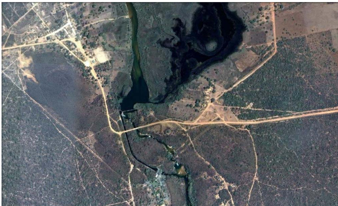
Figura 14.47 -Assoreamento no ribeirão Pandeiros na Usina Hidrelétrica de Pandeiros, no município de Januária. Fonte: Ecoplan-Lume-Skill, 2011.
