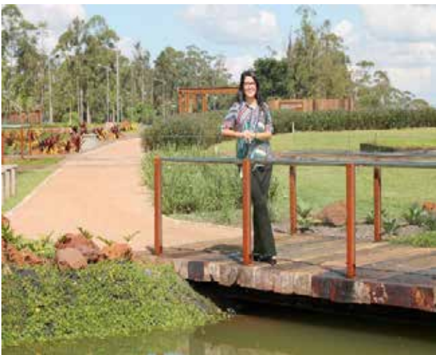
Figura 4 e 5- Piso construído com rejeito de minério e canga para compor o paisagismo. Fonte: Autor, 2017.
