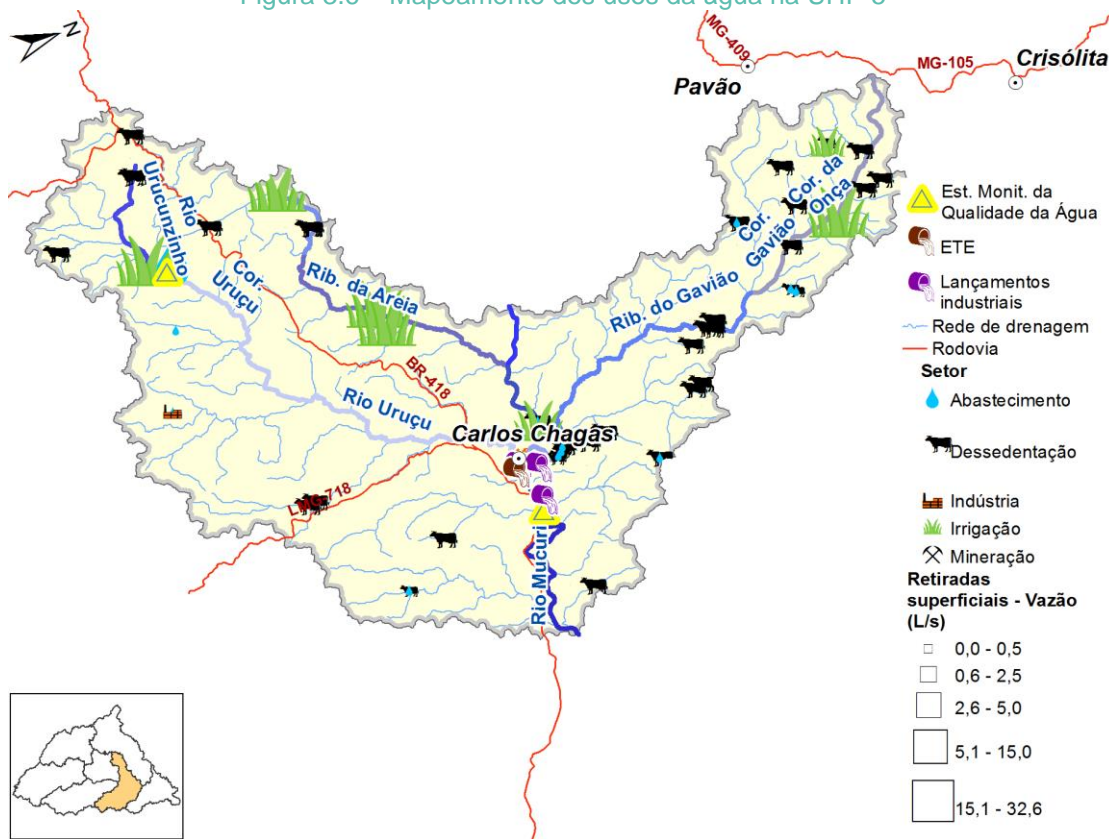
Figura 3.6 – Mapeamento dos usos da água na UHP 5
