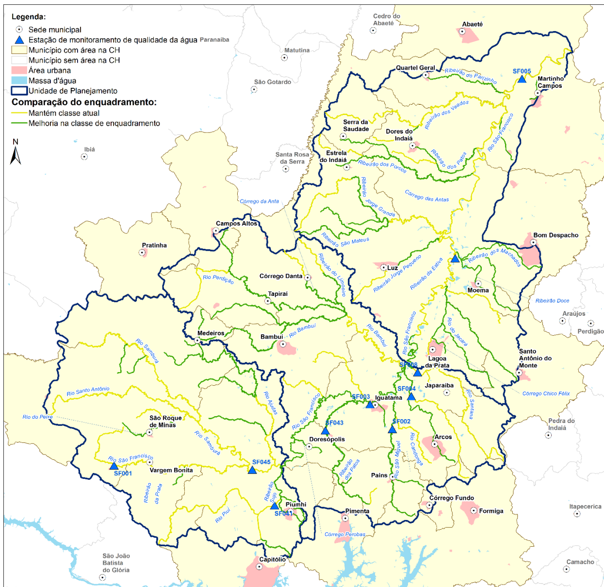
Figura 3.6 – Comparação do enquadramento proposto com a situação presente, na ocorrência da vazão de referência Q 7,10 .
