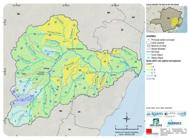
Figura 5.7 – Vazão q<sub>95%</sub> Incremental nas Regiões Homogêneas
