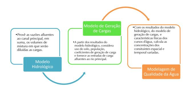
Figura 10.9 – Sistema de Modelos Utilizados para a Modelagem da Qualidade das Águas da Bacia Hidrográfica do Rio Doce
