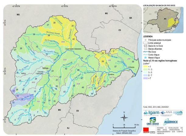
Figura 5.8 – Vazão q<sub>7,10</sub> Incremental nas Regiões Homogêneas
