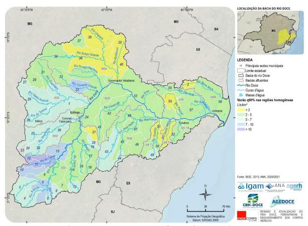
Figura 5.6 – Vazão q<sub>90%</sub> Incremental nas Regiões Homogêneas
