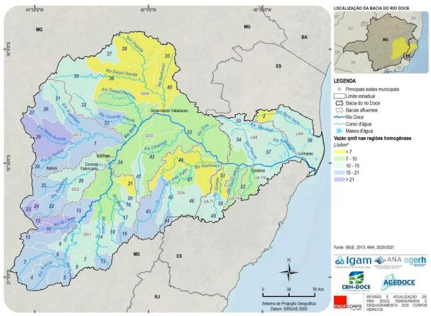
Figura 5.5 – Vazão q<sub>mlt</sub> incremental nas Regiões Homogêneas
