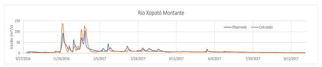
Figura 10.12 – Exemplo de Resultado de Calibração do Modelo Hidrológico da Bacia Hidrográfica do Rio Doce
